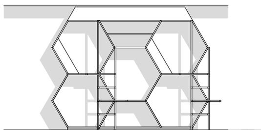
Um das Besteigen des Zwischenraumes zur Decke zu verhindern, kann über der Wabe eine Blende aufgebaut werden.
